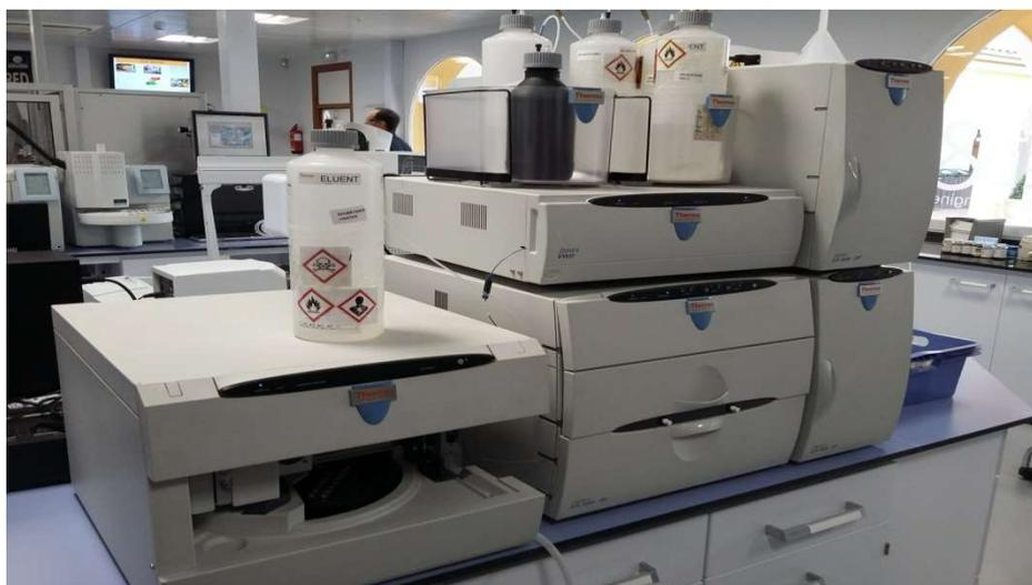
8. Equipo cromatógrafo de gases para determinación de etilenglicol.
